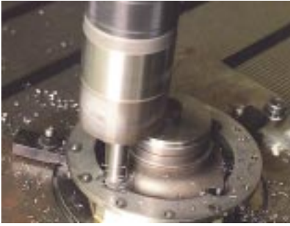
Ausspindeln eines Kupplungsflansches aus einsatzgehärtetem Stahl
