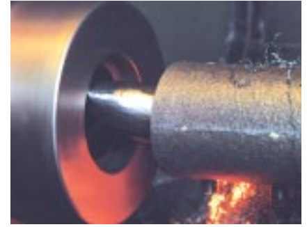
Ausspindeln der Bohrungen für Flurfördererräder aus gehärtetem Stahl mit WTC01
