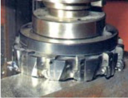
Fräsen von gehärteten Führungsleisten mit Rundplatten aus Voll-CBN
