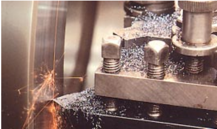
Fertigbearbeitung eines 450 mm - Kegelrades aus 20 Cr Mo 5 Stahl (58 - 60 HRC) mit WTC01 in einem Schnitt.
